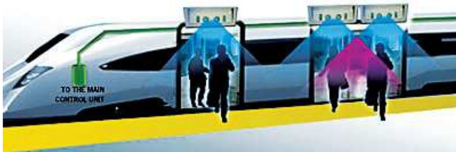
IL CONTEGGIO DEI PASSEGGERI IN ENTRATA E IN USCITA DAL TRAM VIENE EFFETTUATO AVVALENDOSI DI UN DISPOSITIVO DI VISIONE INTELLIGENTE DENOMINATO DYNAPCN, UN CONTATORE DOTATO DI SOFISTICATI ALGORITMI PER IL RICONOSCIMENTO E L'INTERPRETAZIONE DELLE IMMAGINI IN MOVIMENTO E DEI RELATIVI PATTERN.
