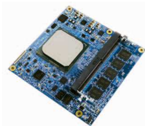
La CPU-161-18 con processore Intel Xeon D-15xx.
