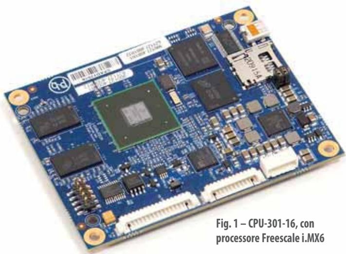
Fig. 1 – CPU-301-16, con processore Freescale i.MX6
