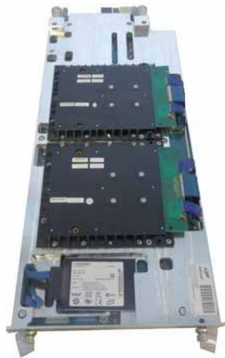
Fig. 3 – ACPU-20-10, scheda che può raggiungere picchi di 3,4 TFlop/s a 900W di picco
